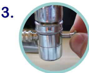
3. Ouvrez le robinet et tirez le bouton sur le déviateur pour dévier l'eau vers le filtre. Utilisez uniquement de l'eau froide avec le filtre.
