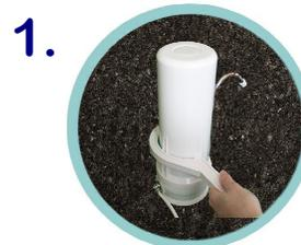
1. À l'aide de la clé fournie, dévissez le(s) boîtier(s) dans le sens contraire des aiguilles d'une montre. Si c'est très serré, demandez à quelqu'un d'autre de tenir la base du boîtier.
